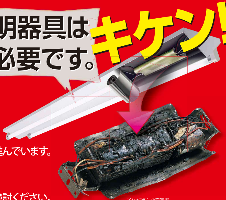
劣化が進んだ安定器
